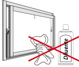
Evitare l'uso di prodotti che potrebbero compromettere la protezione anticorrosione della ferramenta.
