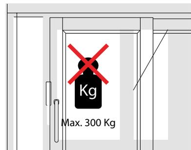
Non caricare pesi sul battente. I carrelli supportano fino a un massimo di 300 kg.
