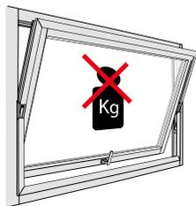
Non caricare pesi sull'anta. La portata delle cerniere varia a seconda del modello.
